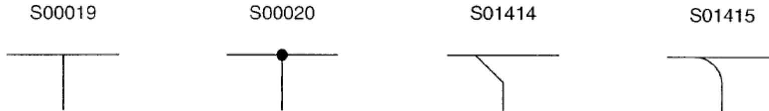
**Bild 15 – Graphische Symbole für die Verzweigung von Verbindungslinien**
